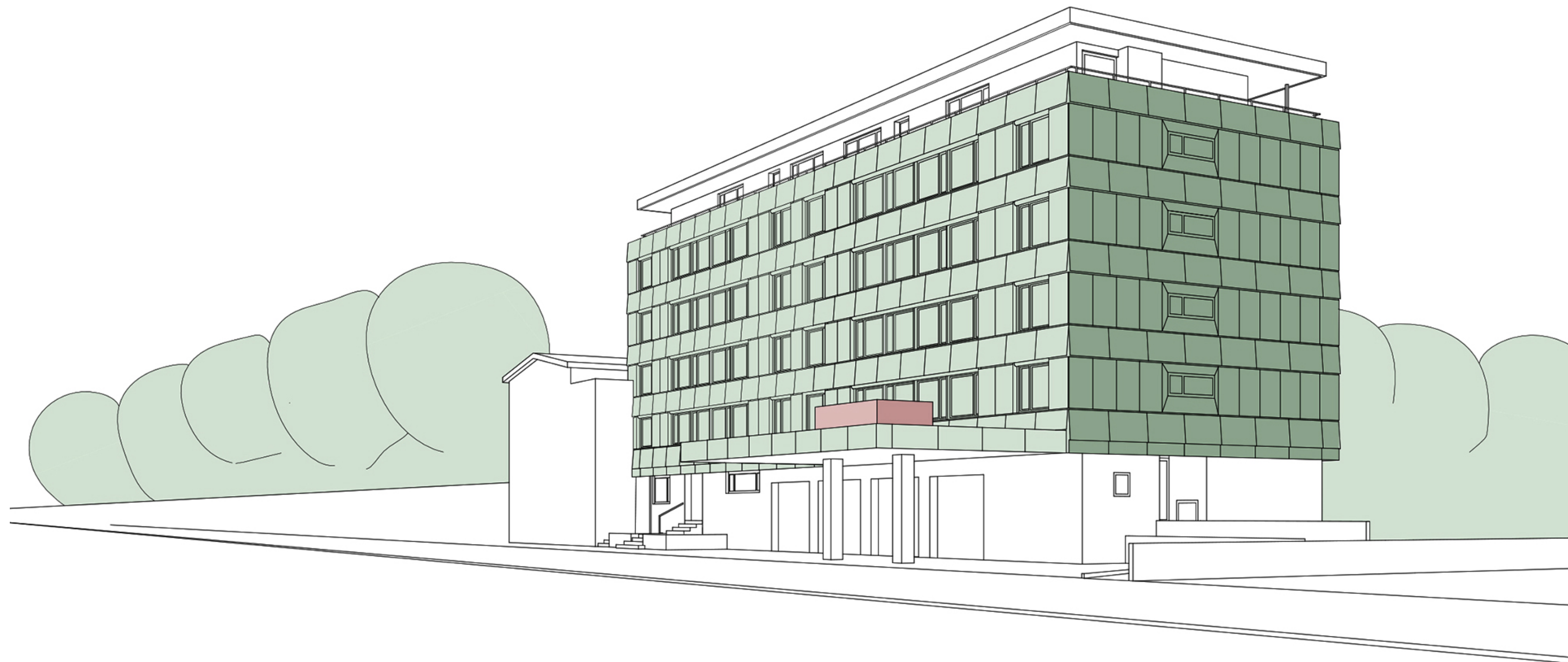
PV Fassade aus Standardelementen 100 × 167 cm, dunkelgrün (RAL 6009)
